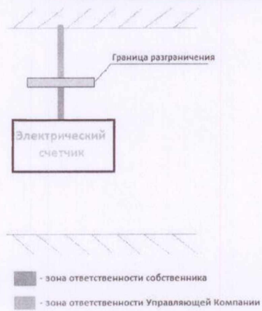
Граница разграничения ответственности по электрическому снабжению
